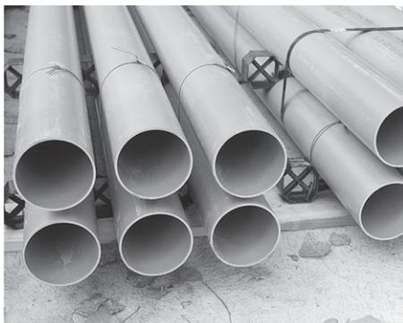
**Стоковые воды химически агрессивны, поэтому канализационные трубы делаются из химически инертных материалов (цемента или пластика, иногда алюминия)**
