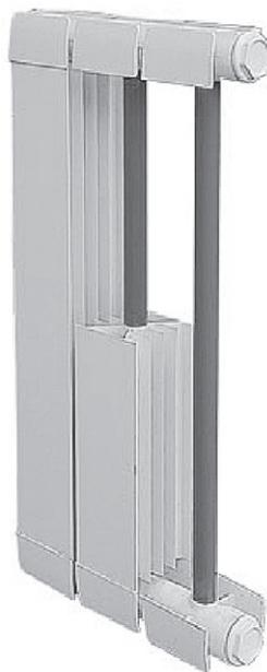
Устройство биметаллического радиатора
